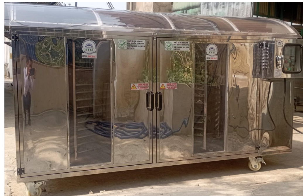
Máy sấy NLMT 50 kg sản phẩm công suất điện 0,6 kW.
